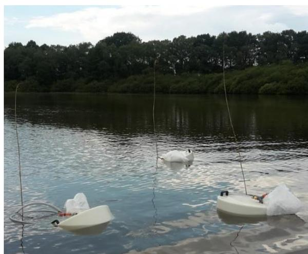
Abbildung 11: Drei Seepage-Meter vor dem Einbau am Untersuchungsstandort „Ostufer“. Alle drei Seepage-Meter sind in der modifizierten Form mit längerem Schlauch ausgestattet.
