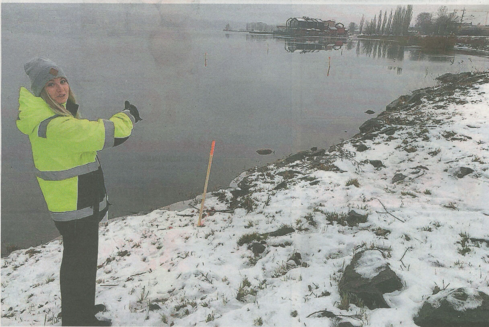
Utredningsingenjör Josefin Andersson, Arvika kommun, är med och mäter istrycket i Kyrkviken inför ett eventuellt byggande av en flytbrygga mellan Sågudden och hamnplan vid Olssons Brygga. Mätningen sker med hjälp av regler längs enslinjer, tre linjer ingår i mätningen.
