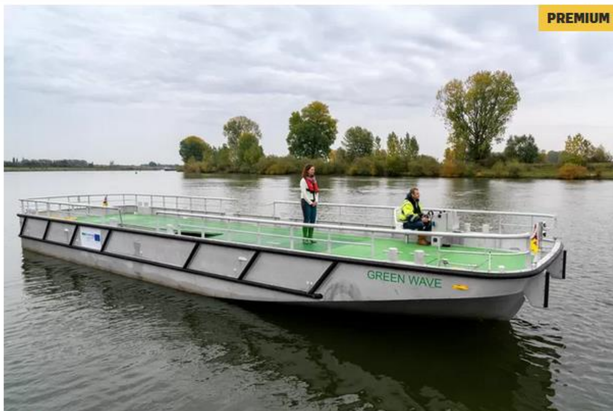
▲ De Green Wave, de vrachtboot met elektrische aandrijving. © copyright Marc Bolsius
