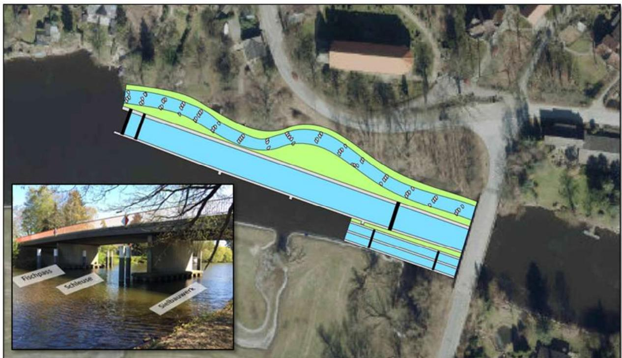
Abb. 40: Konzeptionierung der Mittelschleuse mit Sielbauwerk und Fischaufstieg
