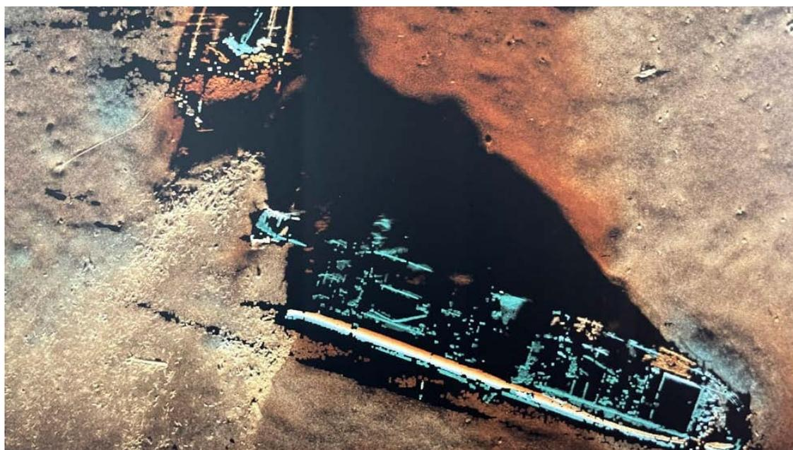
Das Sonarbild zeigt ein Kriegsschiff, das in der Meerenge von Skagerak auf Grund liegt. Die Munitionsreste sind als hellere Punkte zu erkennen
